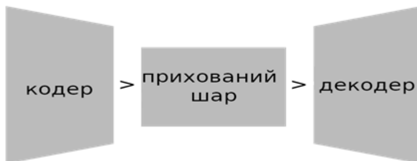
Рисунок 2 – Схематичне зображення згорткової нейронної мережі - автокодера
